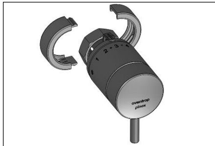
Abb. 1 Thermostat „pinox D“ mit Decoring
