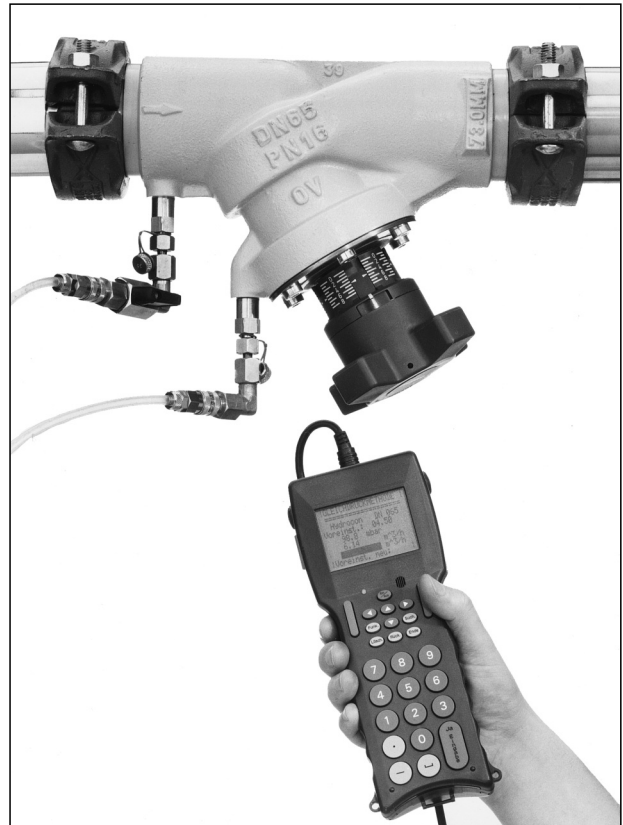
Компютър за измерване на диференциалното налягане „OV-DMC 2“ Прод.номер: 106 91 77 с „Hydrocontrol VGC“ DN 65
