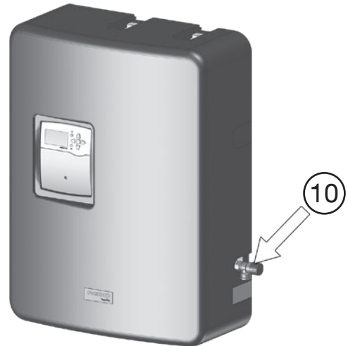
Abb. 6.3: Position Sicherheitsventil Trinkwasser an Station
