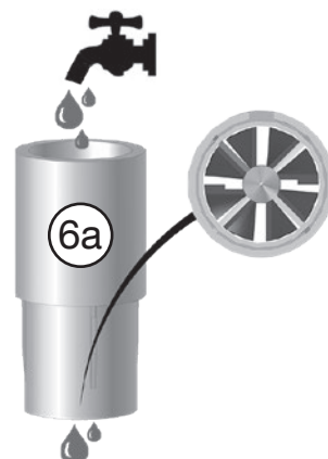
Abb. 5.18: Messturbine unter fließendem Wasser reinigen
